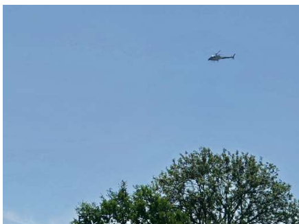
Vom Hubschrauber aus wird im Auftrag der Netze BW aus mehr als 100 Metern Höhe die Vegetation gescannt und dokumentiert. Daraus lassen sich präzise 3D-Modelle erstellen. Foto: Otto
